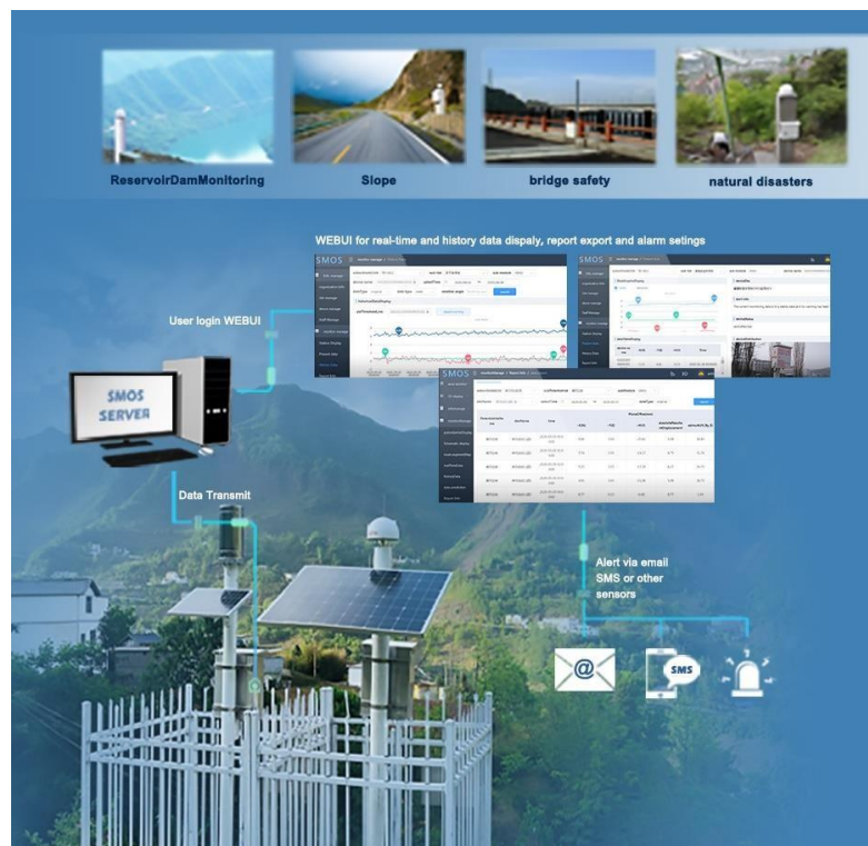
Gambar 3. Sistem Kerja Software Automatic Monitoring System (SAMS) Untuk Monitoring Muka Air Tanah Sumur Pantau Provinsi DKI Jakarta
